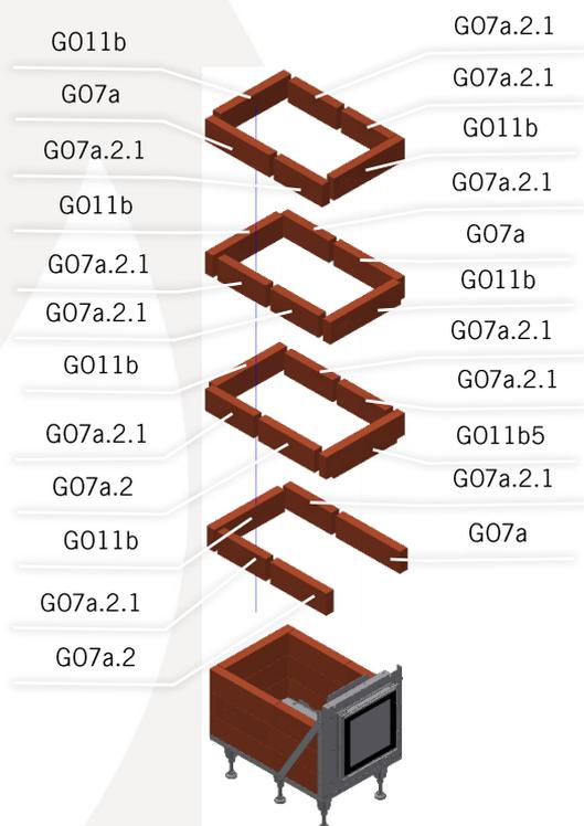
Bevor Sie mit den Mantelsteinen über die Tür mauern, ist diese mittels den seitlichen Klemmleisten winkeltgerecht zur Bodenplatte auszurichten und festzuschrauben.
