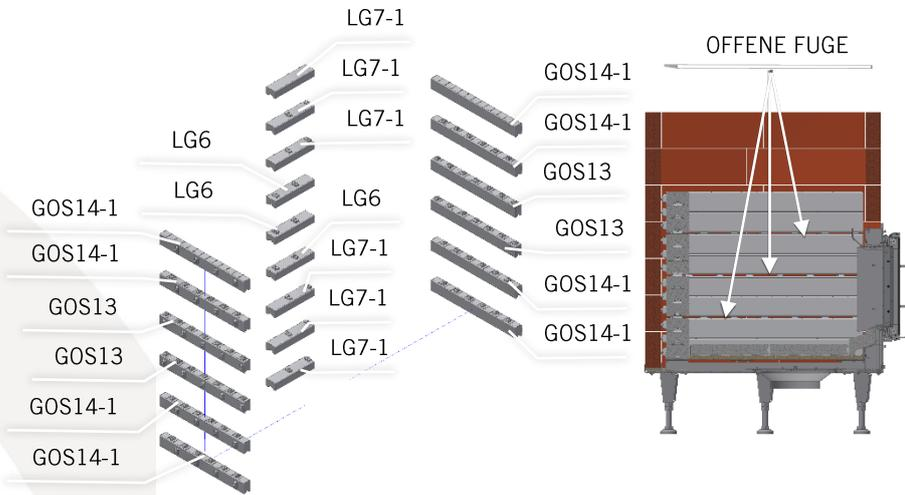
Setzen Sie nun die restlichen Reihen der GOS auf. Dabei muss nach jeder 2. Reihe umlaufend ein 6 mm Luftspalt zwischen den Steinen entstehen.
