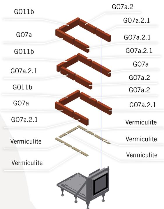
Setzen Sie zunächst die 1. Reihe der Mantelteile trocken auf die Fasermatten ins Grundgestell.
