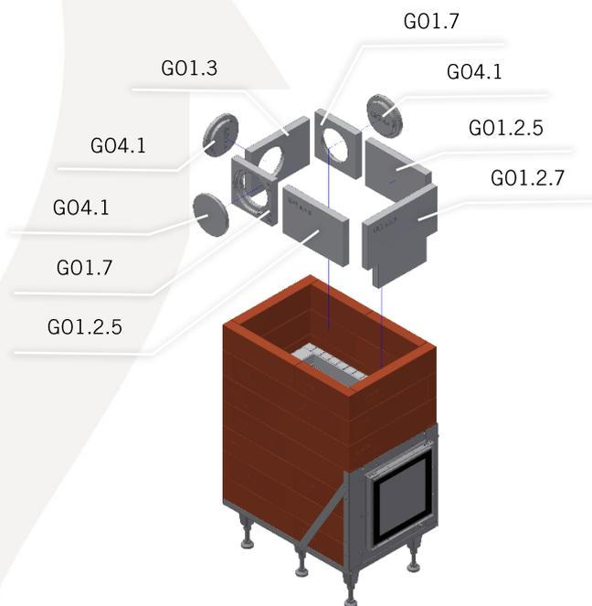
Versetzen Sie die Teile der Nachverbrennungskammer trocken. Bei nicht geschlossenen Fugen (abhängig von der Fugenstärke beim Aufbau der roten Mantelsteine) sind die Fugen mit Keramikfaser abzudichten. Die Nachverbrennung ist jedoch nicht untereinander zu verkleben.
